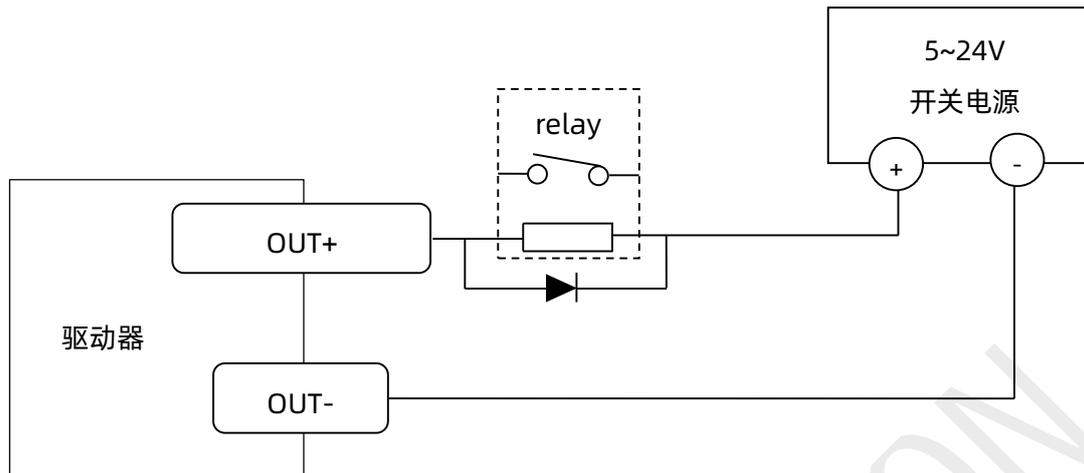
※注意：请勿将输出端接至 30V 以上的直流电压，流入输出端的电流请勿超过 10mA。
