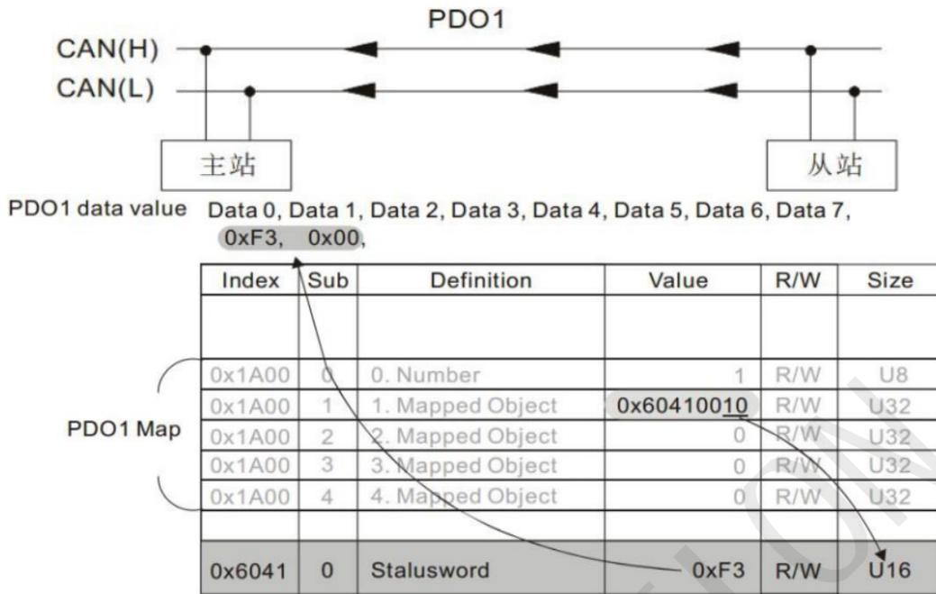
下图较详尽的表述了 PDO 参数(1800H)与 PDO 映射(1A00H)之间的关系及 PDO 数据的传输过程(以节点 2 为例), 图示箭头的方向表示从站数据处理方向。
