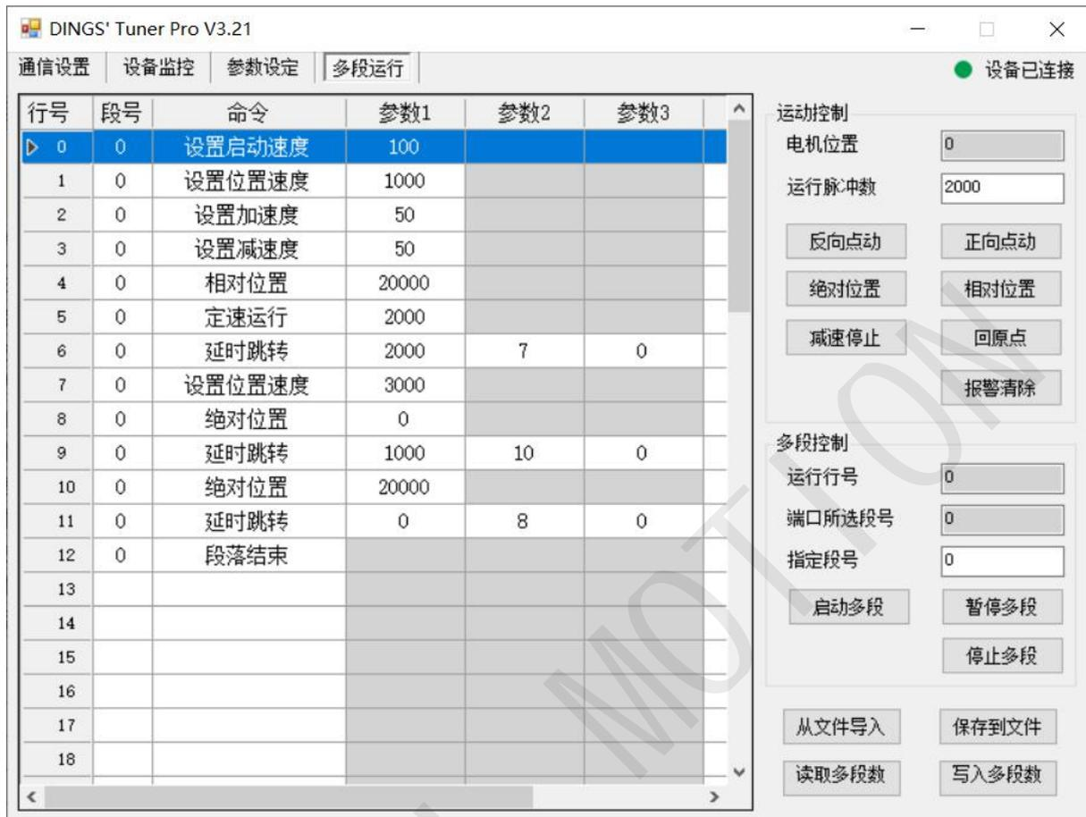
这是一个多段，0-3 行设置了运行的参数，第 4 行相对运动运行到了 20000，然后第 5 行以 2rps 的速度开始运行，第 6 行设定运行了 2s，然后跳转到第 7 行，然后第 8 行重新设定了位置速度为 3rps，以 3rps 的速度绝对位置运行到 0，然后第 9 行延时了 1s，跳转到第 10 行，绝对位置运行到 20000，然后第 11 行延时 1s 跳转到第 8 行，不断循环。第十一行段落结束标志着多段的结束。
