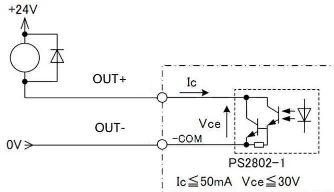
※注意：继电器连接时，要求在继电器两端接二极管（如 IN4000 系列）
